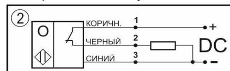
Цоколевка клеммной колодки
